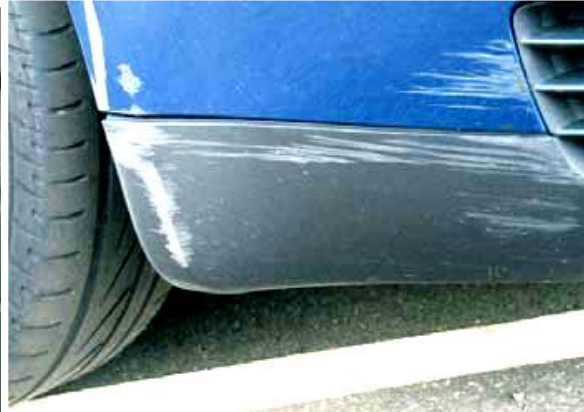
Niet aanvaardbaar, door de lak heen
