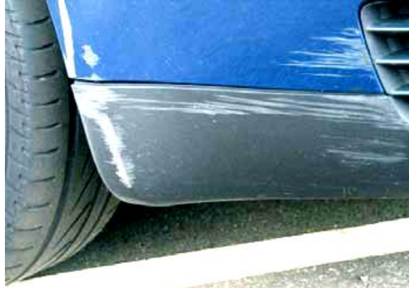
niet aanvaardbaar, door de lak heen
