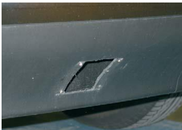
niet aanvaardbaar, trekhaak verwijderd
